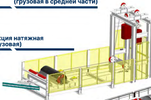
Секция натяжная (грузовая в средней части)
